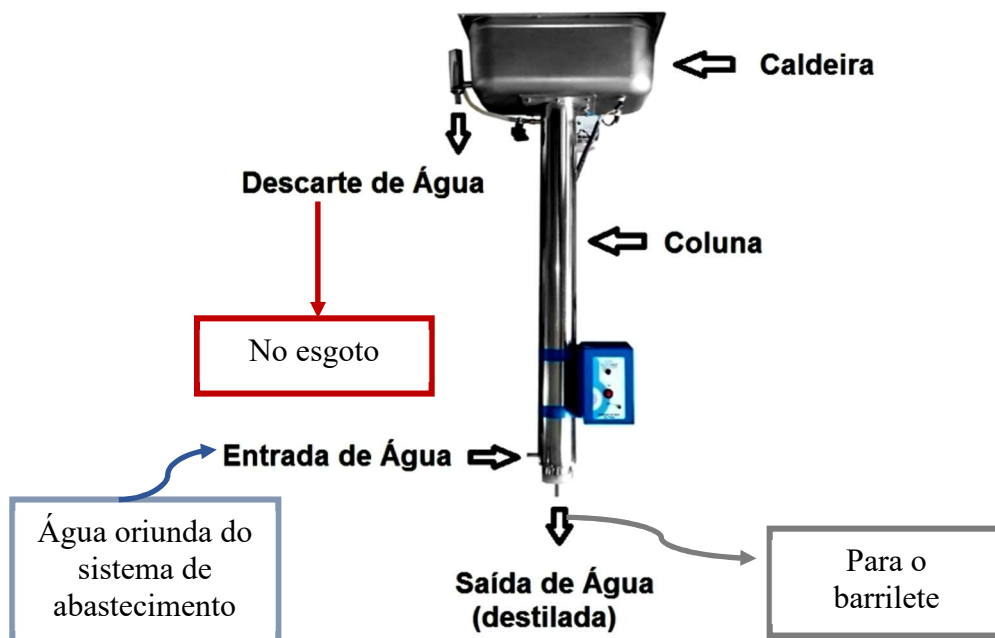
Figura 13 – Destilador de água tipo Pilsen, suas partes e circuito da água
